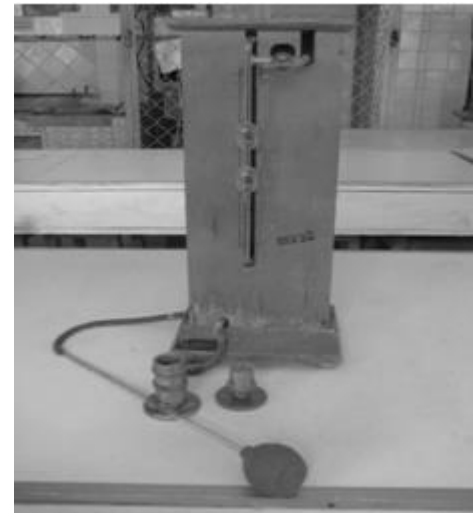
Abb. 3 – Das Gerät T-3 für die Feststellung der spezifischen Oberfläche der feinteiligen Stoffe.
