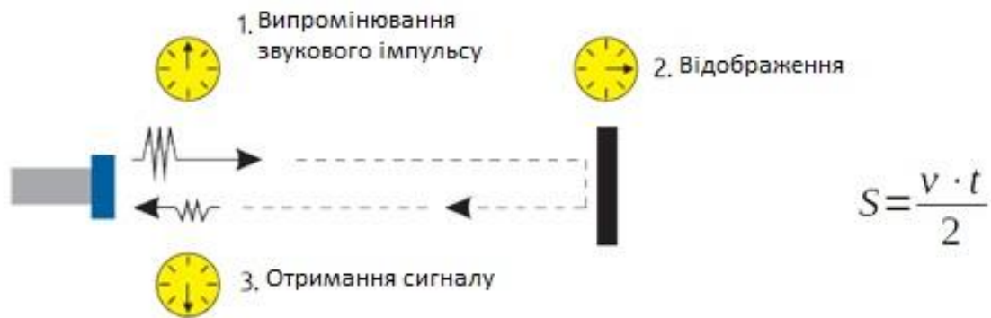
Рисунок 2 – Схема роботи ультразвукового датчика
