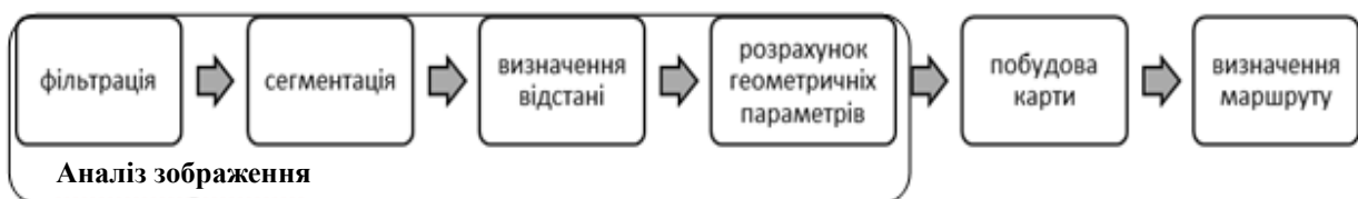
Рис. 1. – Процес прийняття роботом рішення щодо побудови маршруту
