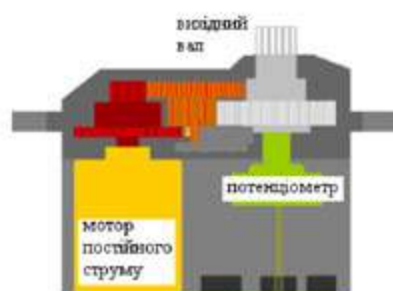
Рисунок 8 - Схема внутрішніх елементів сервоприводу
