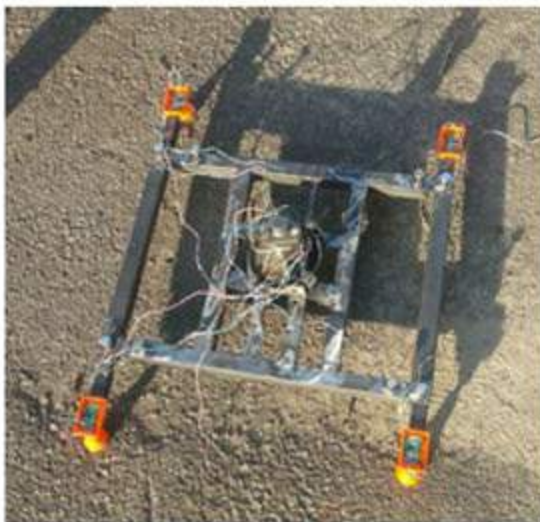
Рисунок 8 – Установка кінцевих опір. виготовлення проводки
