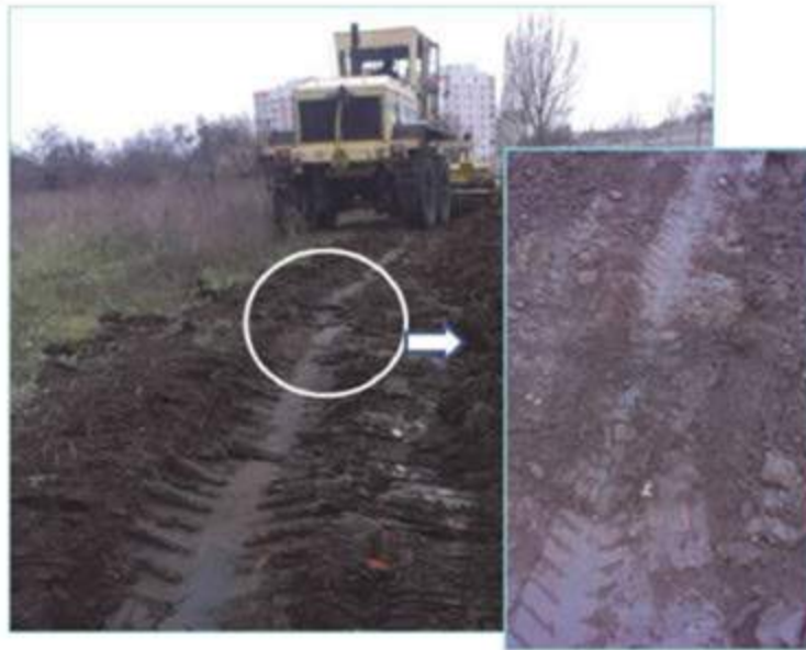
Рисунок 1 — Бічне ковзання заднього моста
