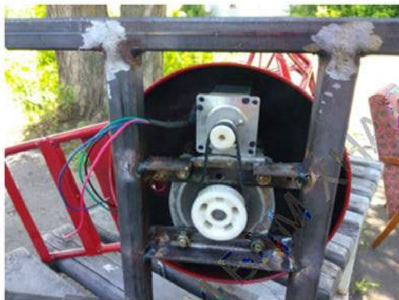
Рисунок 5 – Установка шківів, мотору та збірка вузла обертання моделі крана
