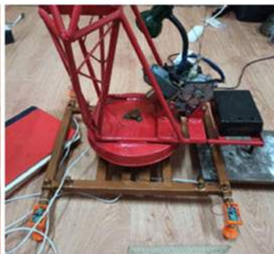
Рисунок 11 – Встановлення тензометричних опор на баштовий кран
