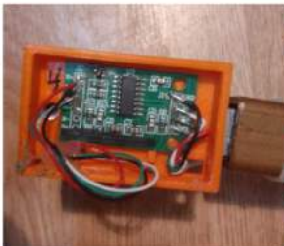
Рисунок 10 – Кінцева опора, установка посилювача НХ711
