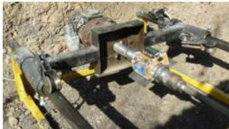
Рисунок 2 – Комплекс для вимірювання крутного моменту встановлений на експериментальному стенді
