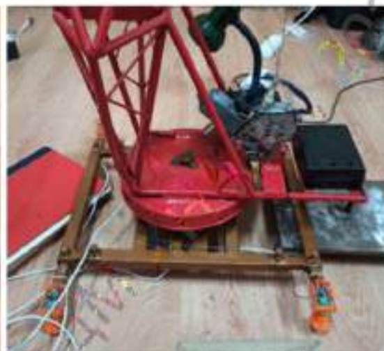
Рисунок 11 – Встановлення тензометричних опор на баштовий кран
