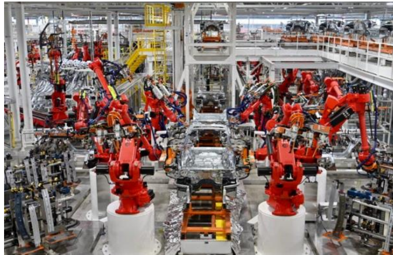
Рис. 1. Використання маніпуляторів при виготовленні кузова автомобіля Jeep Grand Cherokee
