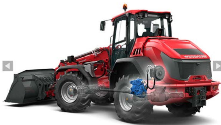
Рисунок 1 – Навантажувач Weideman 9080 з трансмісією на базі аксіальнопоршневого гідромотора з регульованим робочим об'ємом, редуктора і карданних валів
