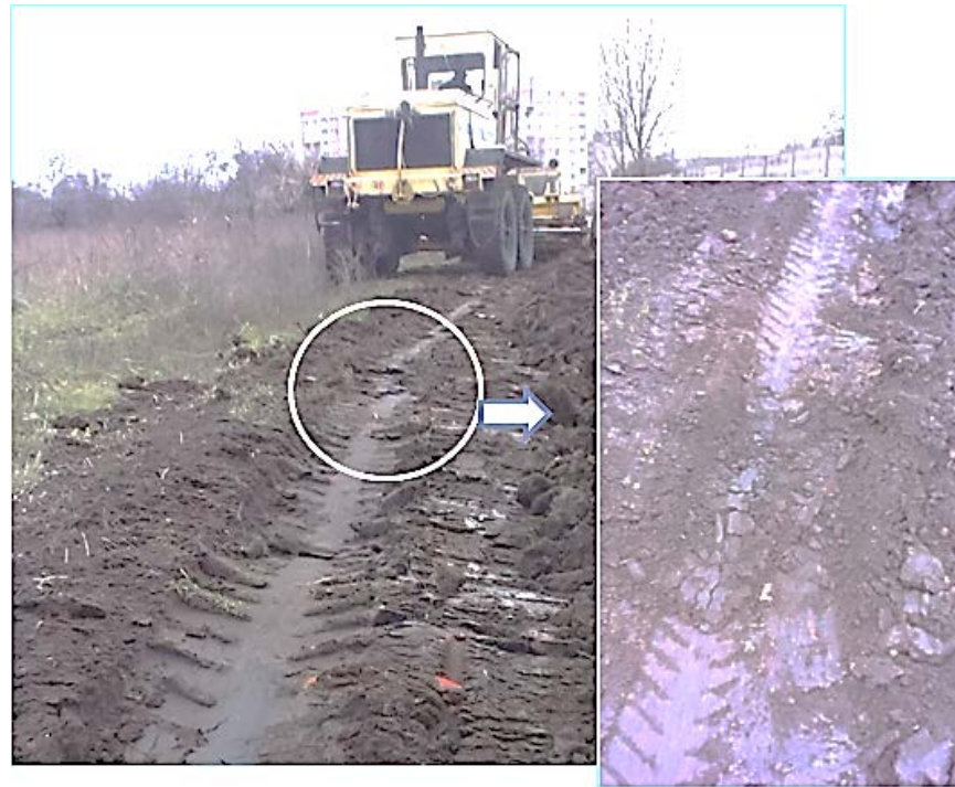
Рисунок 6. Фотограма процесу бокового ковзання машини в ході проведення експерименту
