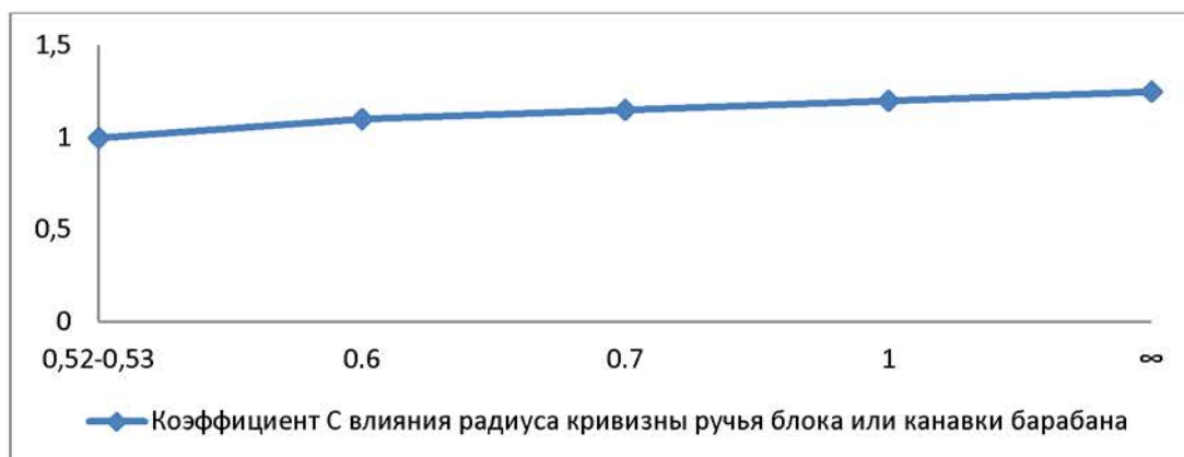
Рис 3 – Коефіцієнт С враховує вплив радіусу кривизни ручія блоку або канавки барабану.
