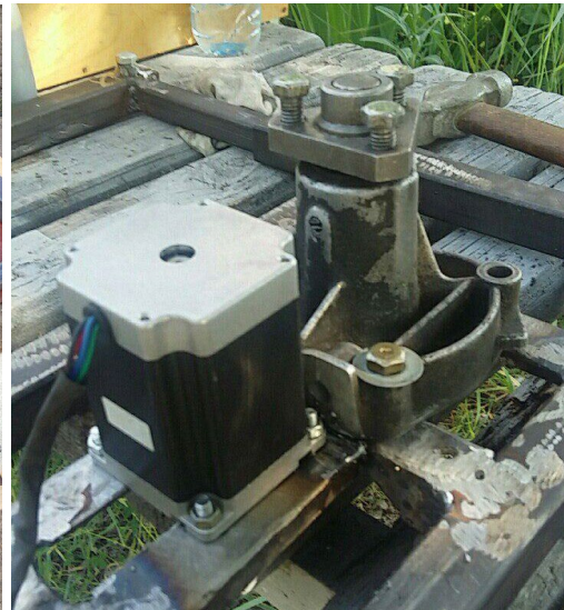
Рисунок 4 – Установка мотора осі обертання
