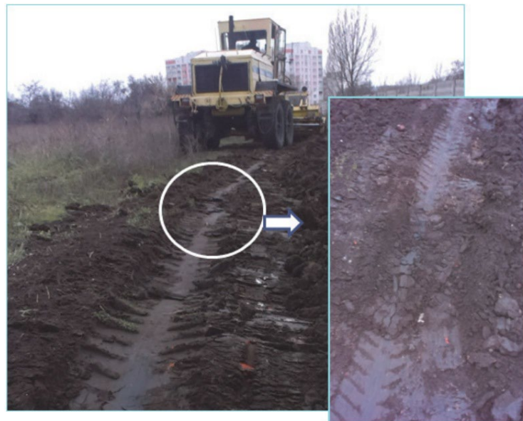
Рисунок 1 — Бічне ковзання заднього моста
