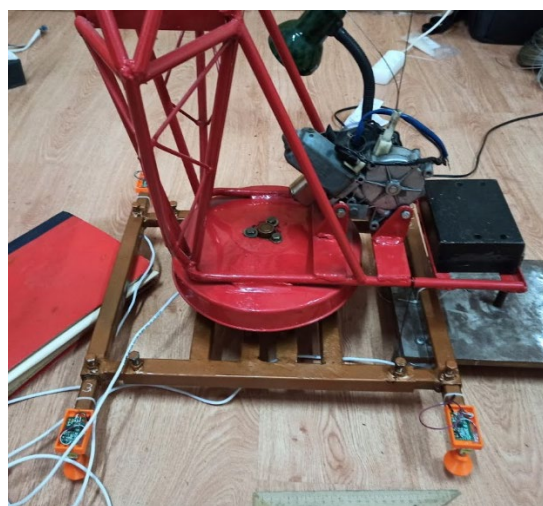
Рисунок 11 – Встановлення тензометричних опор на баштовий кран
