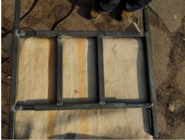
Рисунок 1 – Зварювання моделі телескопічної ходової рами
