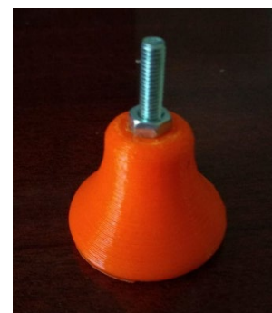
Рисунок 7 – Ніжка кінцевої опори
