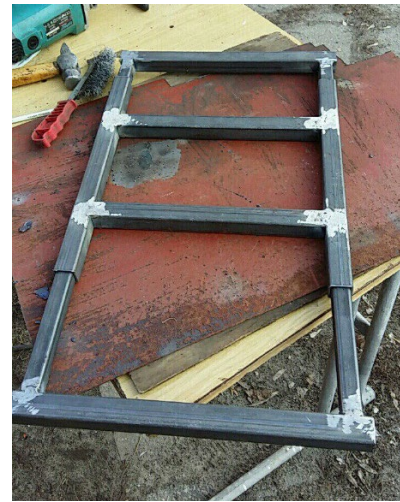
Рисунок 2 – Обробка зварних швів моделі
