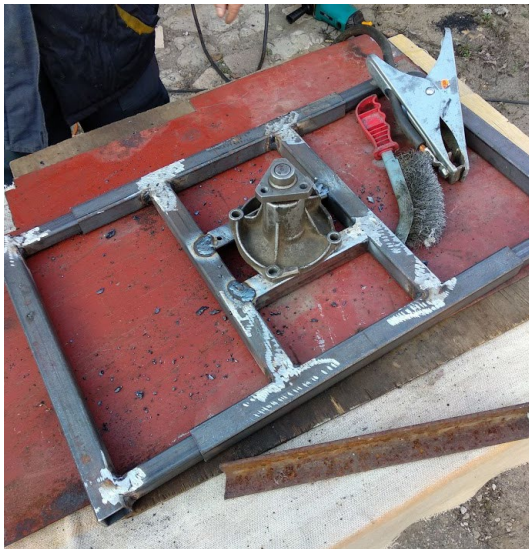
Рисунок 3 – Установка осі обертання моделі крана
