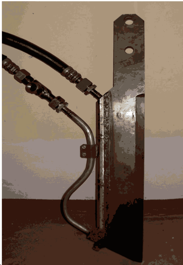
Рис. 1 - Модель ножового робочого органу із генератором дросельних коливань
