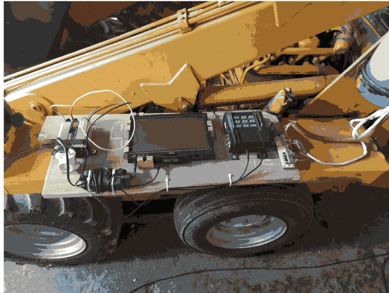
Рис. 3 – Система вимірювання інформації, встановлена на малогабаритному фронтальному навантажувачі
