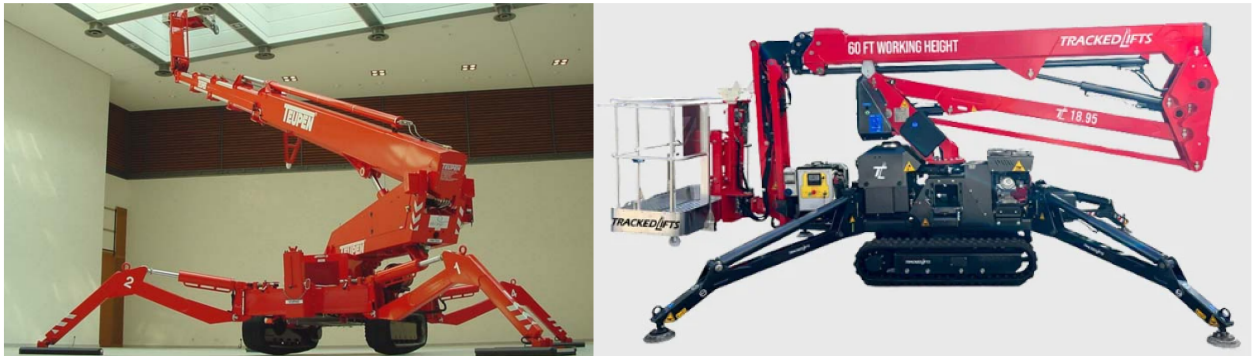
Рисунок 1 – Телескопічні (а) та колінчасто-телескопічні (б) підйомники
