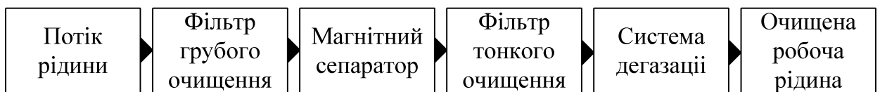
Рисунок 4 – Схема багатоступеневої системи фільтрації робочої рідини
