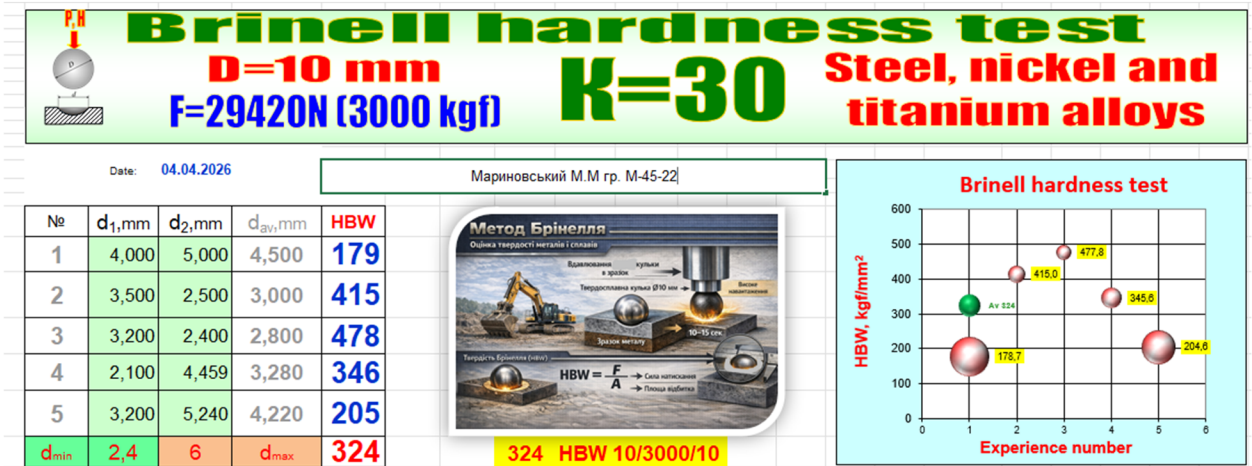
Рисунок 3 – Розрахунок твердості за методом Брінелля та візуалізація результатів
