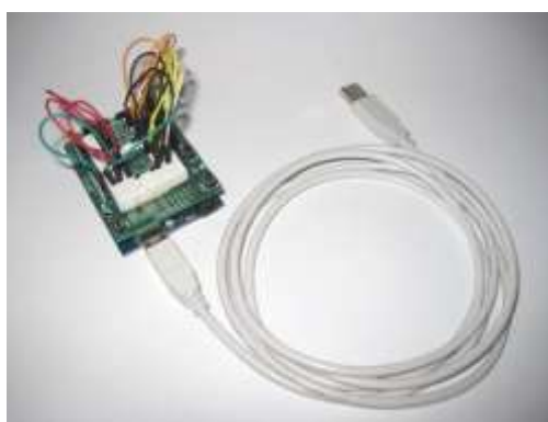
Сенсорний модуль ІДТ - гіроскоп, давачі прискорення
