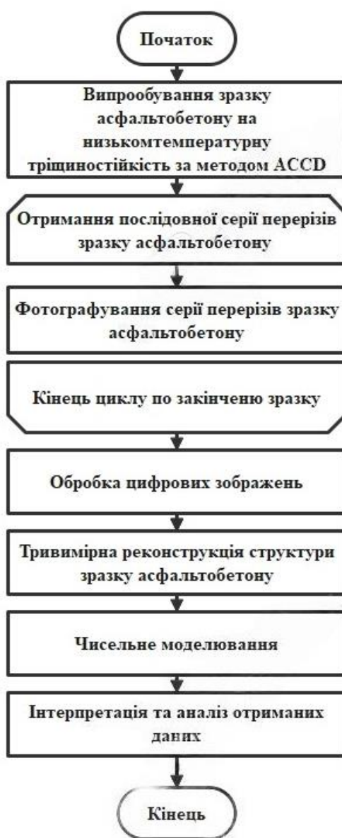
Рис. 1. Схема алгоритму комп'ютерного моделювання структури асфальтобетону
