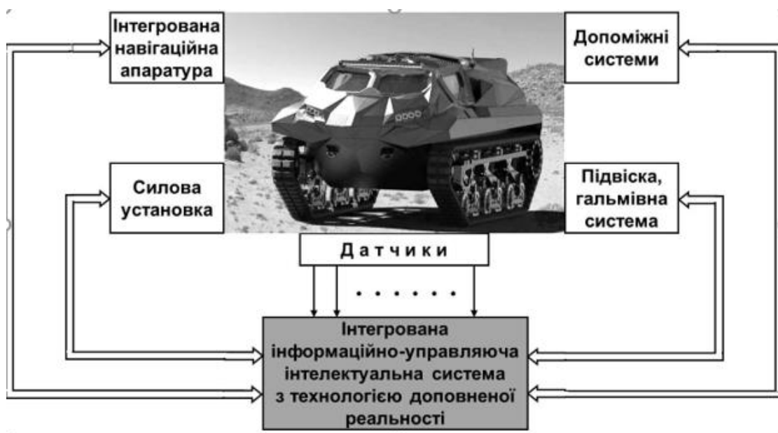
Рисунок 2 – Приклад функціональної схеми комплексу управління багатоцільовим транспортним засобом на основі інтегрованої інформаційно-управляючої інтелектуальної системи з технологією доповненої реальності
