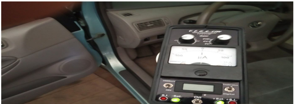
Рис. 8.2 Вимірювання напруженості ЕМП у середині автомобіля (праве переднє сидіння пасажирів)
