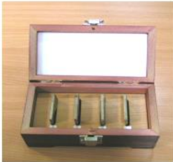
Рисунок 7 — Зразки шорсткості поверхонь (ГОСТ 9378–93)
