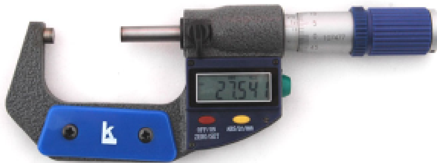
Рисунок 24 — мікрометр гладкий мод. МКЦ(5)-50
