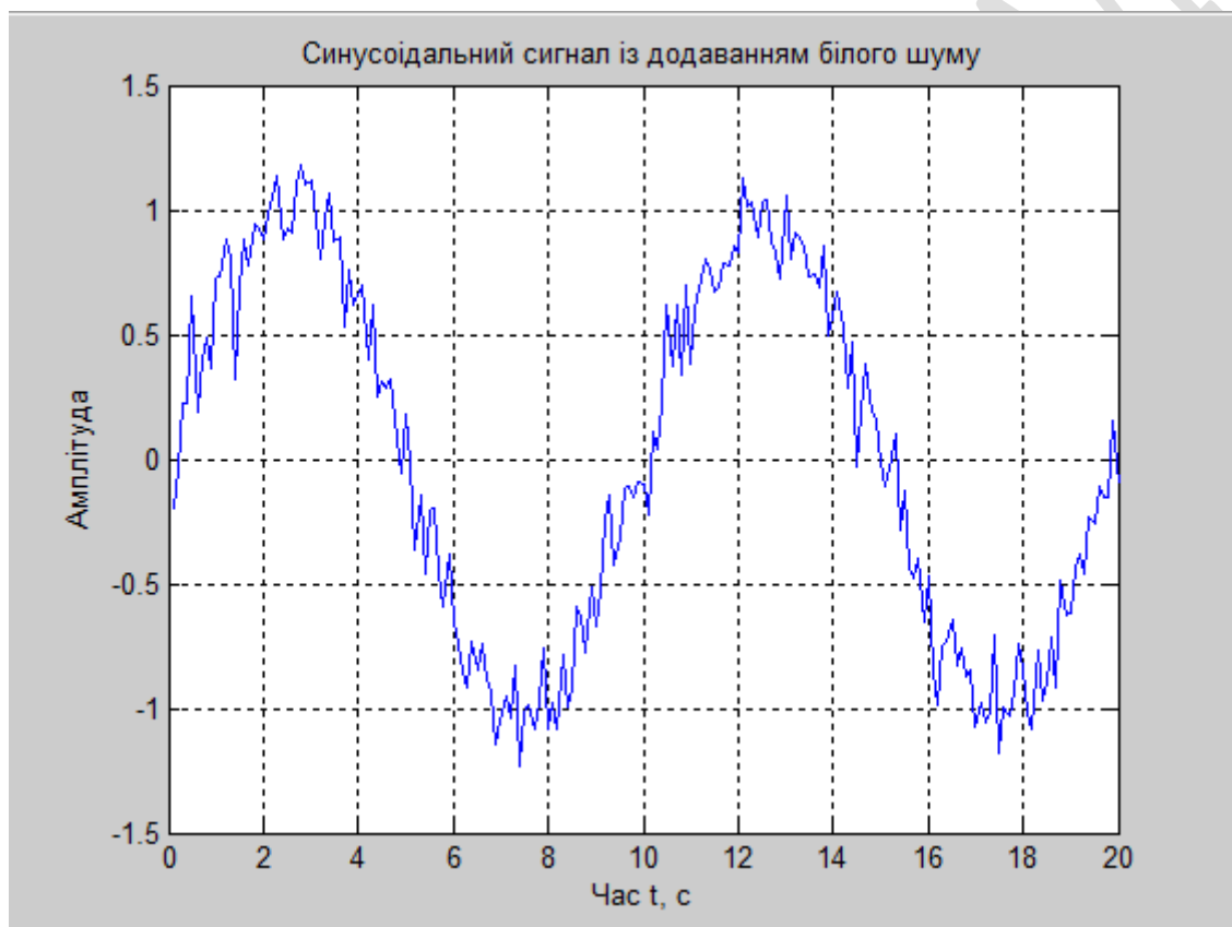
Рисунок 3.14 – Частотно-маніпуляційний сигнал № 2 (Синусоїда + шуми) з силою шуму 10 Дб
