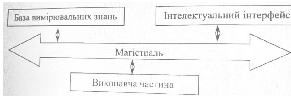
Рисунок 4.1 – Структура інтелектуального вимірювального засобу [3]
