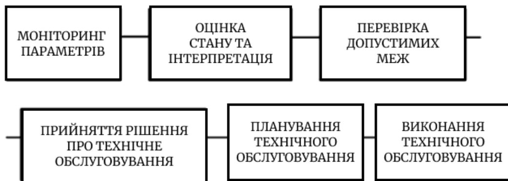
Рисунок 1.1 – Схема дій для прогнозування технічного обслуговування на ТЕЦ
