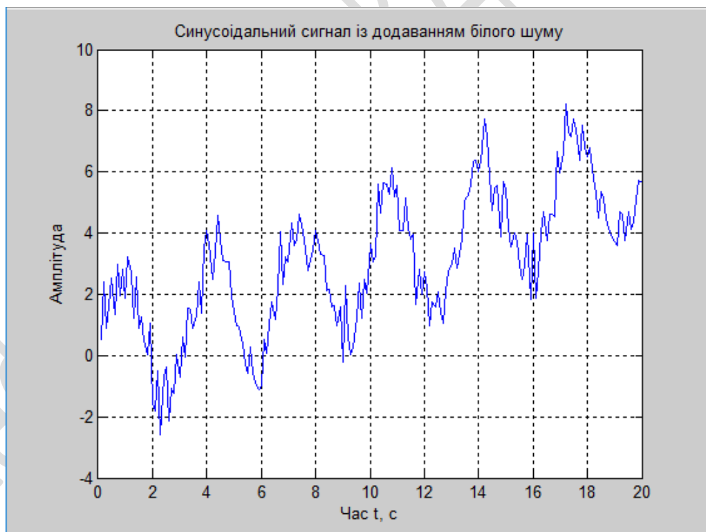
Рисунок 3.20 – Частотно-маніпуляційний сигнал № 5 (Синусоїда + шуми) з відношенням сигнал-шум 50 Дб
