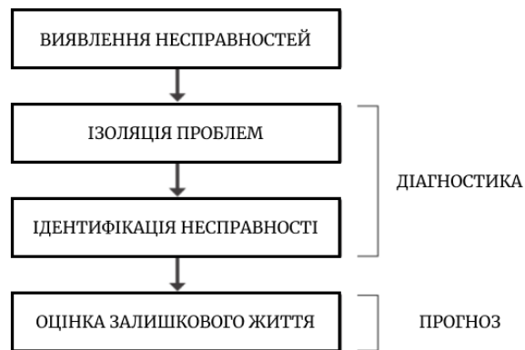
Рисунок 1.3 – Етапи моніторингу стану для підтримки прийняття рішень щодо технічного обслуговування
