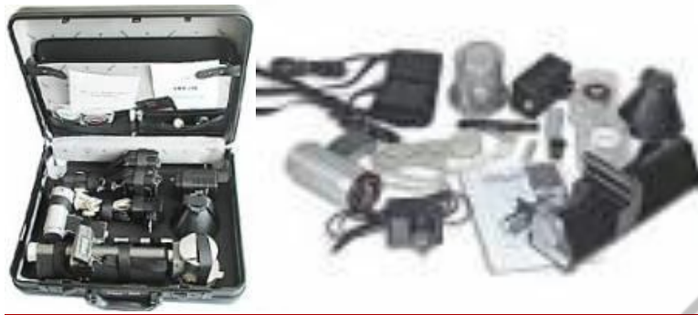
Рисунок 1.3 – Портативний детектор вибухових речовин "МО-2М"
