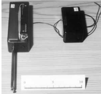
Рисунок 1.6 – Комплект радіолінії керування вибухом
