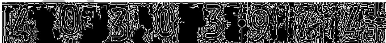
Рисунок 3.11 — Результати виявлення країв цифри за допомогою алгоритму Canny з адаптивним пороговим значенням
