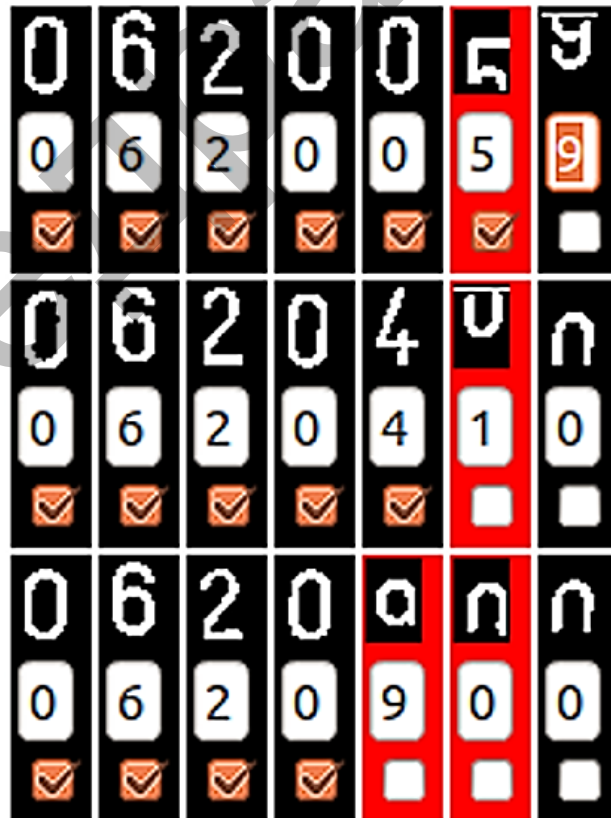
Рисунок 3.19 — Розпізнавання результатів зчитування лічильників
