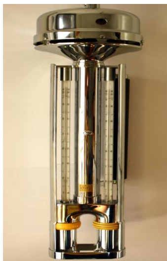
Рисунок 1.1 - Аспіраційний психрометр “Ассмана”
