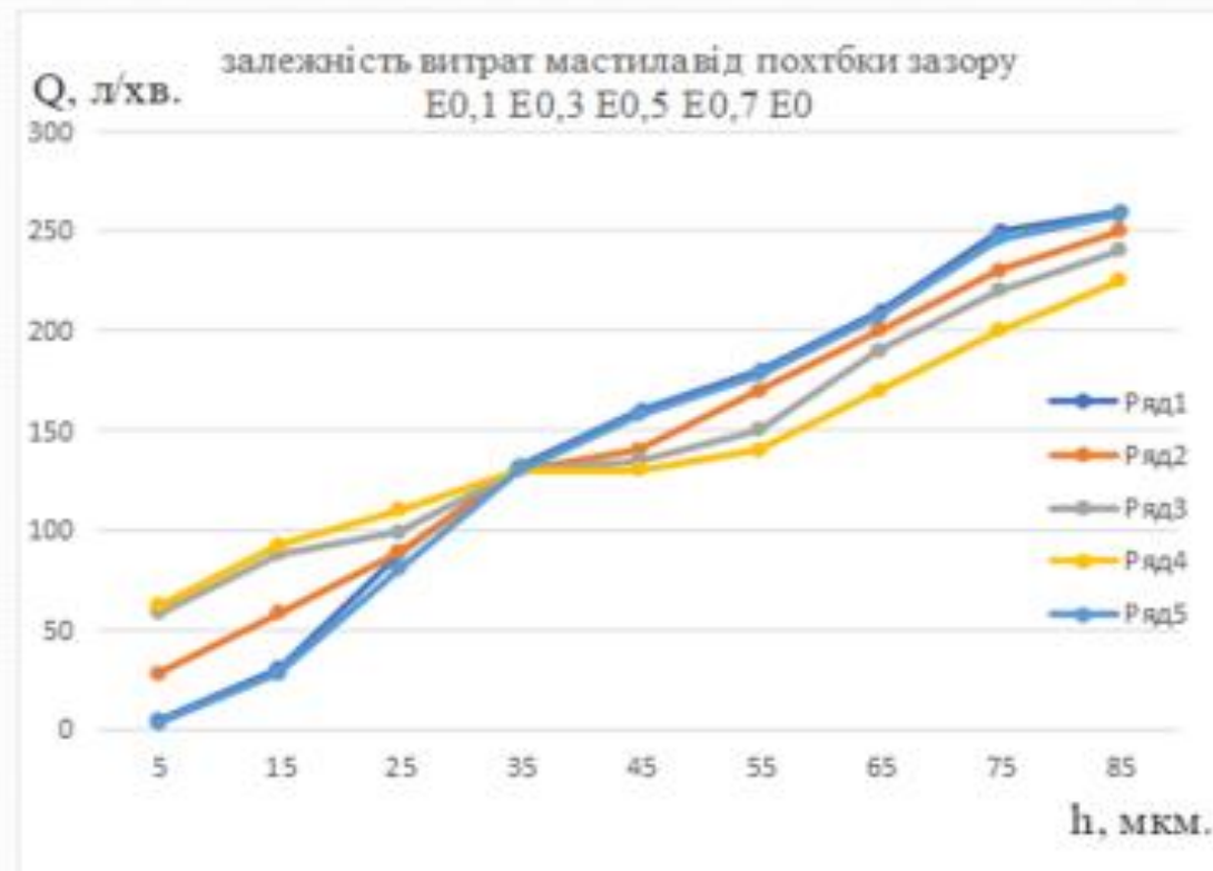
Рисунок 1 – Залежність витрати мастила Q від похибки зазору h
