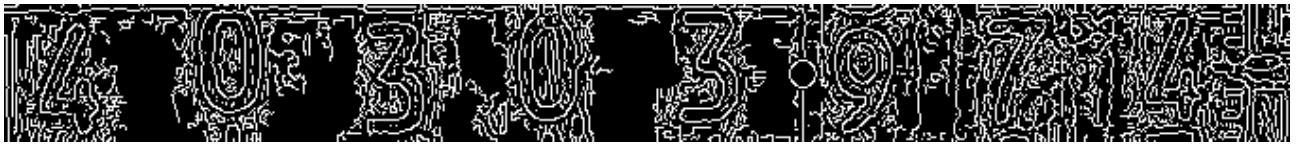
Рисунок 3.11 — Результати виявлення країв цифр алгоритмом Канні з адаптивним порогом
