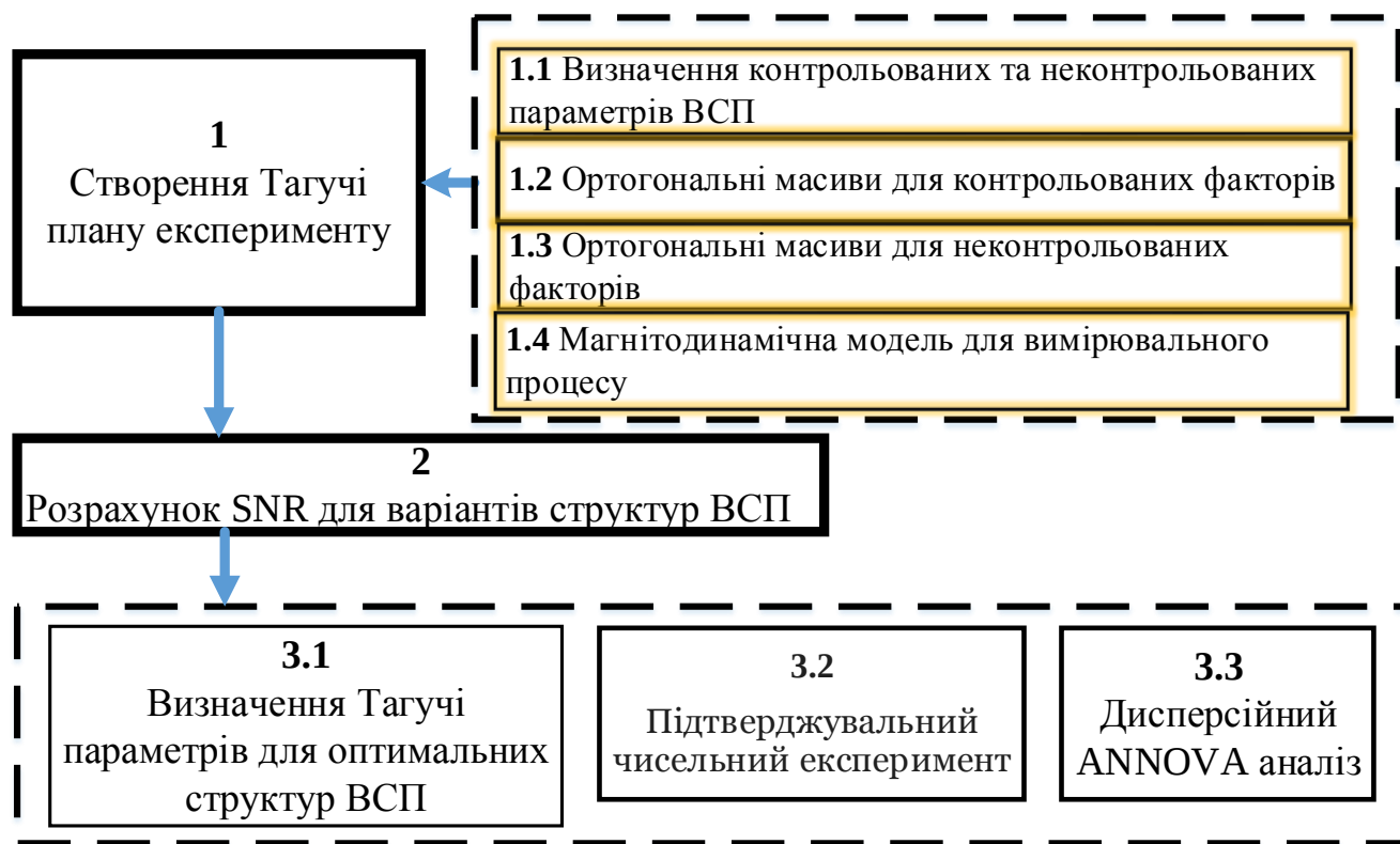
Рисунок 1 – Загальна схема робастного параметричного проєктування вихрострумowego вимірювача магнітної проникності методом Тагучі
