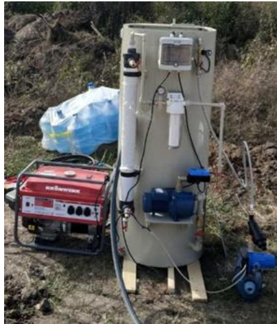
Рисунок 1 – Автономна мобільна установка для комбінованої фільтрації та електрохімічного очищення води до питних стандартів
