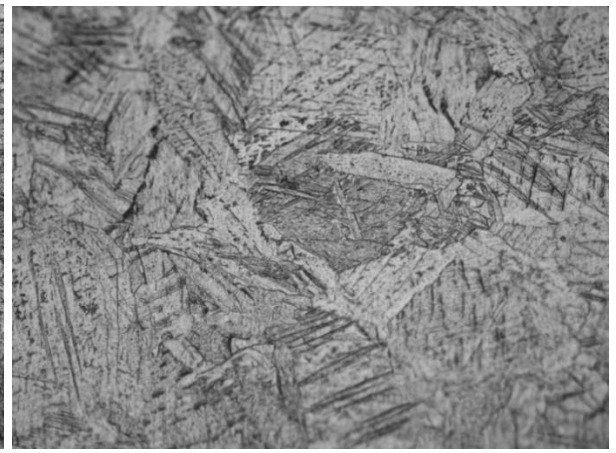
Рисунок 1а - Мікроструктура сплаву ПТ-1М після пресування і охолодження на повітрі (зовнішня поверхня)
