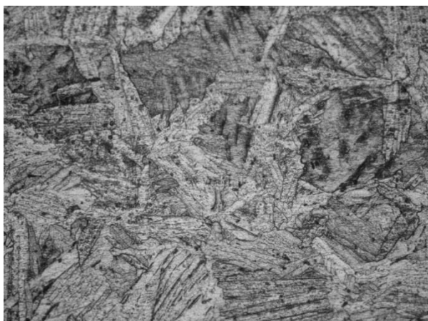
Рисунок 1в - Мікроструктура сплаву ПТ-1М після пресування та охолодження на повітрі (внутрішня поверхня)
