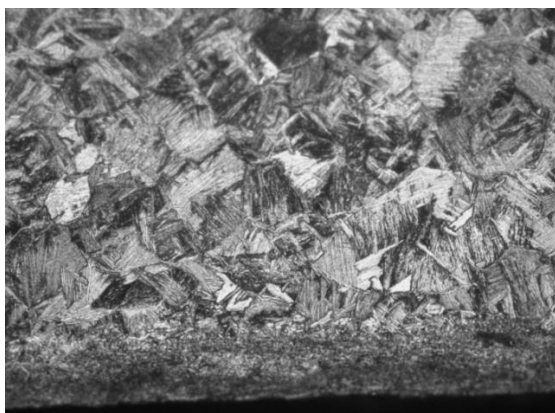
Рисунок 3в - Мікроструктура сплаву Grade 9 після пресування і охолодження на повітрі (внутрішня поверхня)
