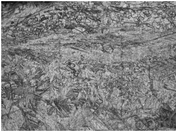
Рисунок 1а - Мікроструктура сплаву ПТ-1М після пресування і охолодження на повітрі (зовнішня поверхня)
