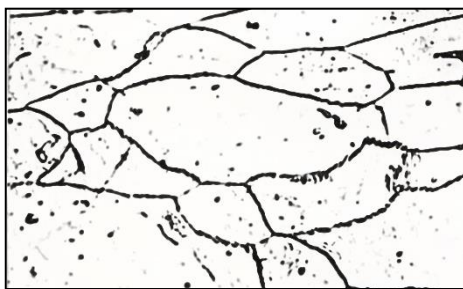
Рисунок 1 – Мікроструктура сталі 08кп у вихідному холоднокатаному стані
