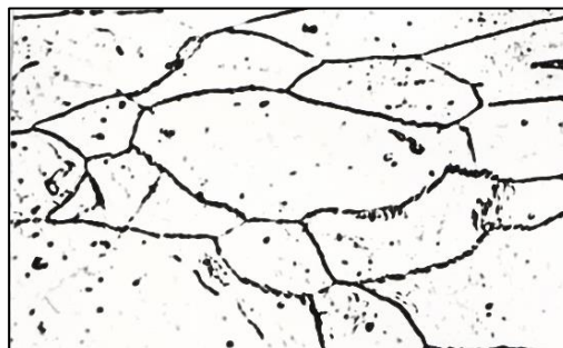
Рисунок 4.1 – Мікроструктура сталі 08 кп у вихідному холоднокатаному стані; \times 500
