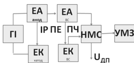
Рисунок 1 - Структурна схема термодинамічних процесів при ЕІО: ГІ - генератор імпульсів; ЕА - анод у вихідному стані; ЕК - катод у вихідному стані; ІР - іскровий розряд; ПЕ - потік електронів; ПЧ - потік часток; ЕАВС - анод у збудженому стані; ЕКВС - катод у збудженому стані; НМС - нестійка модифікована структура; УМЗ - стійка модифікована структура
