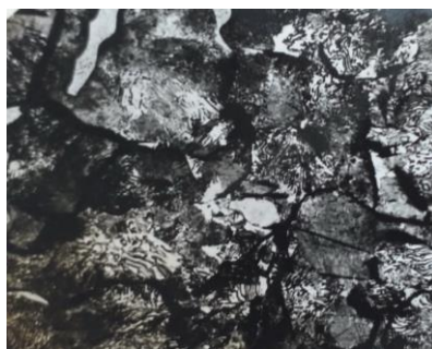
Рисунок 1 – Мікроструктура чавуну в литому стані
