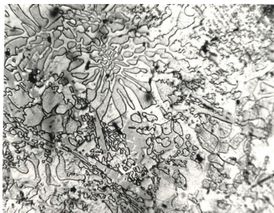
Рисунок 6 – Структура оплавленого шару покриття ПГ-СР4: а – грубі суміші; б – тонкі суміші
