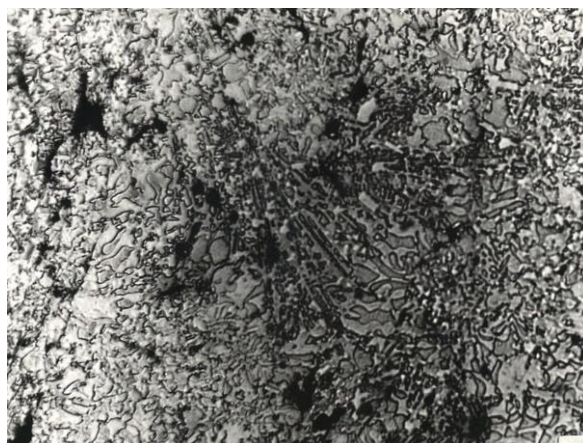
Рисунок 6 – Структура оплавленого шару покриття ПГ-СР4: а – грубі суміші; б – тонкі суміші
