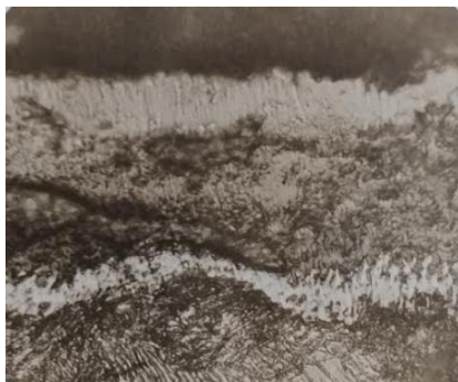
Рисунок 5 – Мікроструктура чавуну після сульфоціанування при температурі 560 °C на протязі 3-х годин 30 хвилин (зразок знаходився на дні ванни) (режим В)
