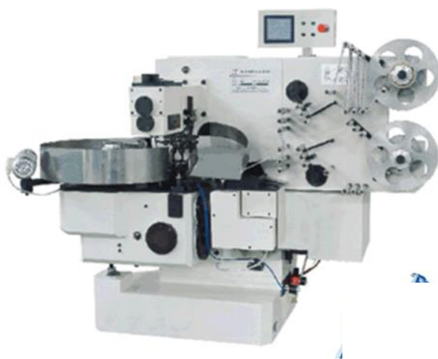
Рис. 4. Завёрточная машина NYS-800 ДАБЛ-ТВИСТ [4, с. 43]
