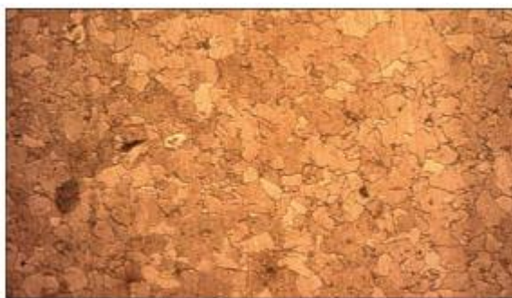
Рисунок 4 - Начальна стадія первинної рекристалізації. Структура металу шву на сталі 10ХМФ (напрацювання зварних з'єднань 276 тис. год)
