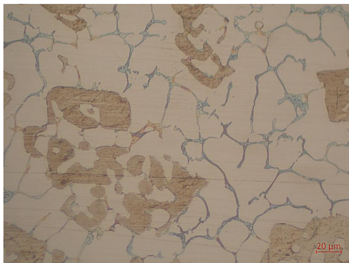
Рисунок 3 – Мікроструктура отриманого сплаву (x500)
