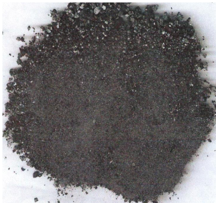
Рисунок 2 – Змішана дрібна фракція магнітної і немагнітної шихти від утилізації боєприпасів
