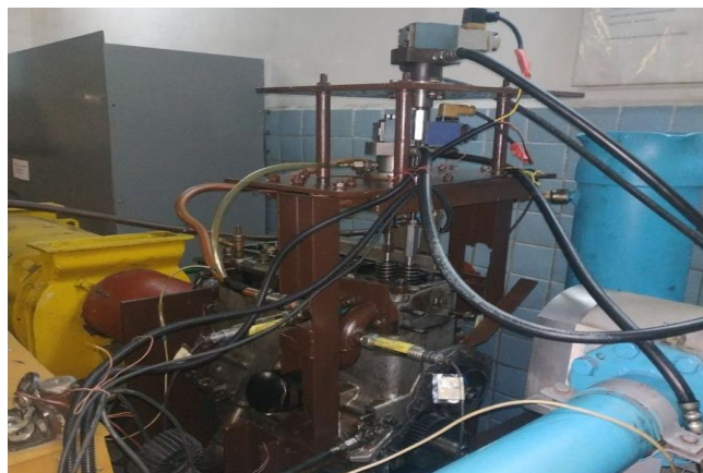
Рисунок 2 – Електрогідропривід клапанного механізму
