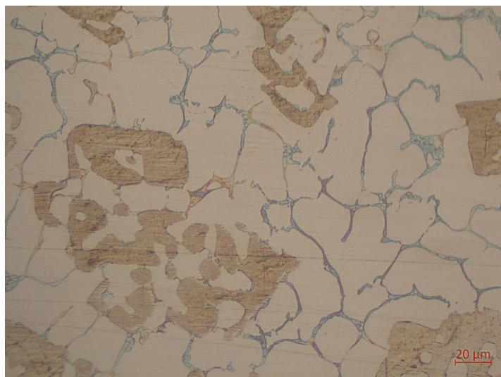
Рисунок 3 – Мікроструктура отриманого сплаву (x500)
