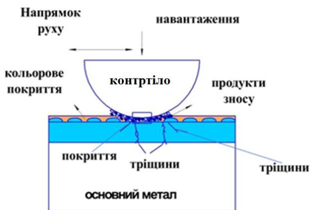
Рисунок 1 – Схематичне зображення фреттинг-знос
