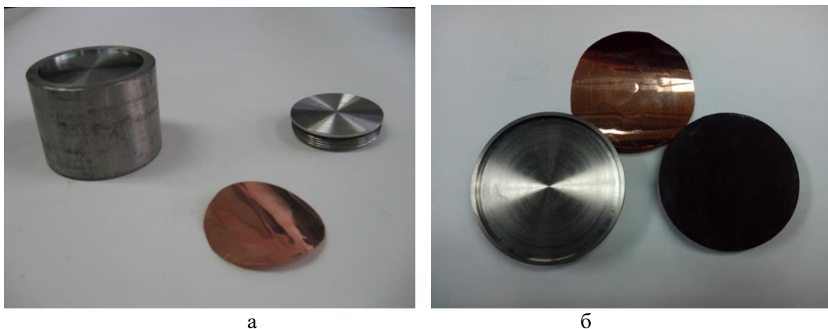
Рисунок 2 - Катод з молібдену (а), катод з графіту (б)
