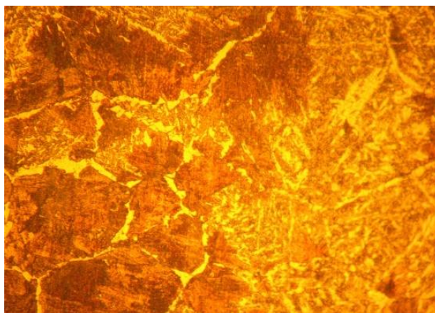
Рисунок 2 – Мікроструктура сталі 34XH1MA у стані постачання, \times 250
