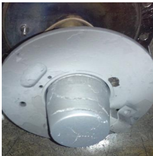
Рисунок 1 - Фотографія паяного хромового катода з тріщинами
