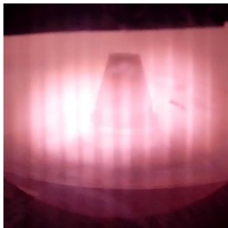
Рисунок 7 - Нагрівання і пайка деталей в двухступеновому розряді при позитивному потенціалі.
