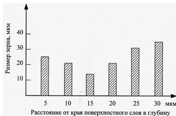
Рисунок 1 – Гістограми розміру зерна від краю в глибину
