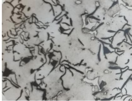
Рисунок 1 – Мікроструктура чавуну в литому стані, не травлено, \times 200
