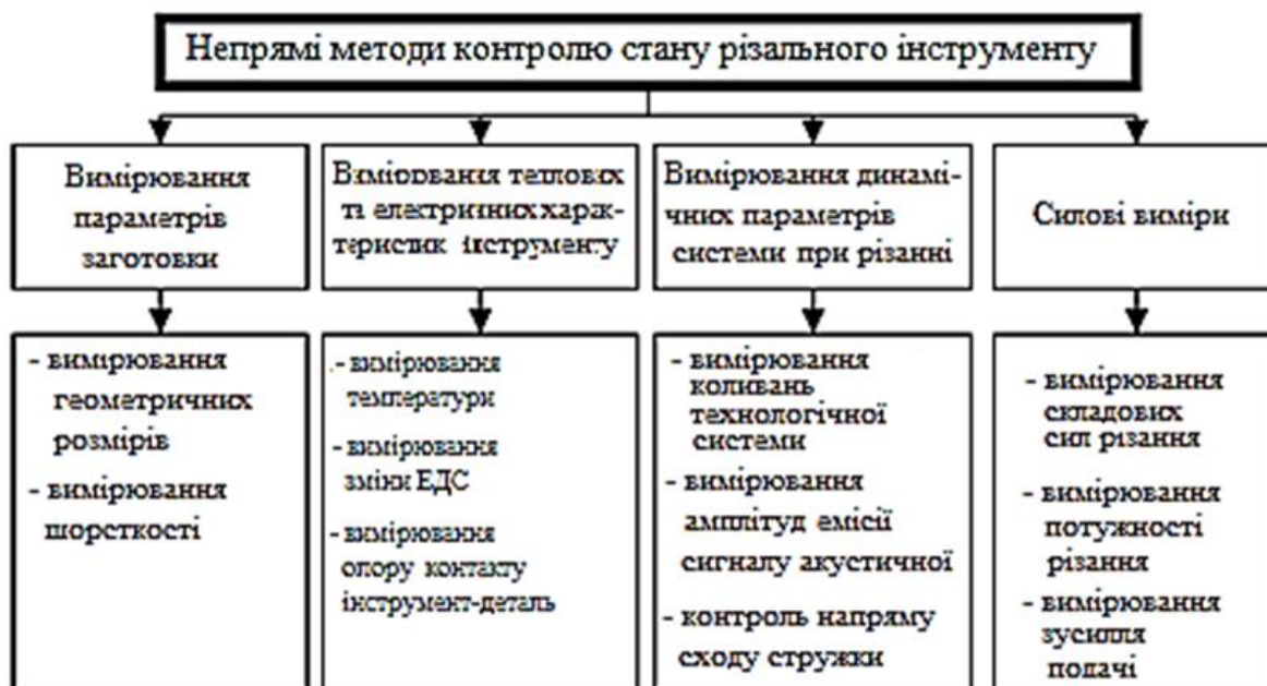
Рисунок 2 – Непрямі методи контролю стану різального інструменту
