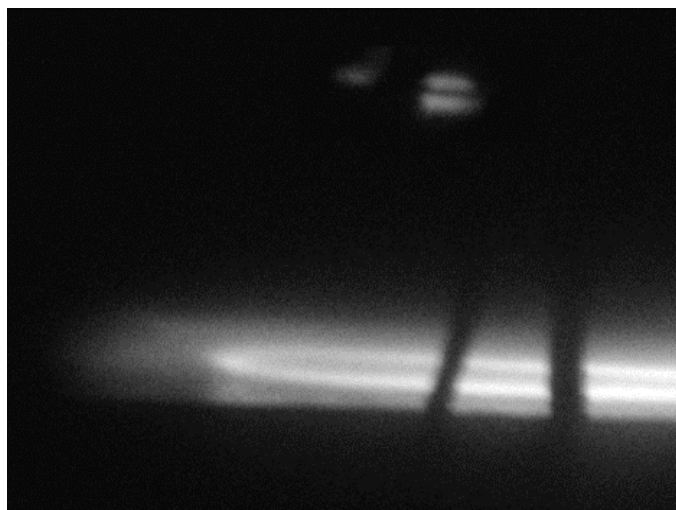
Рисунок 1 – Тліючий розряд у магнітному полі при тиску 150 Па
