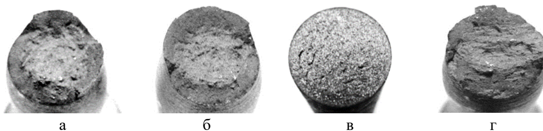
а – покращення; б – азотований шар 0,08 мм; в – 0,25 мм, г – знятий азотований шар Рисунок 3 – Злами розривних зразків
