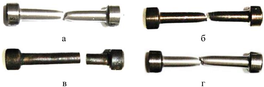
а – покращення; б – азотований шар 0,08 мм; в – 0,25 мм; г – знятий азотований шар Рисунок 2 – Зруйновані зразки при розтяганні
