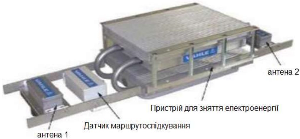
Рисунок 3 – Приклад використання системи бездротового живлення для одночасної передачі даних та здійснення маршрутослідкування
