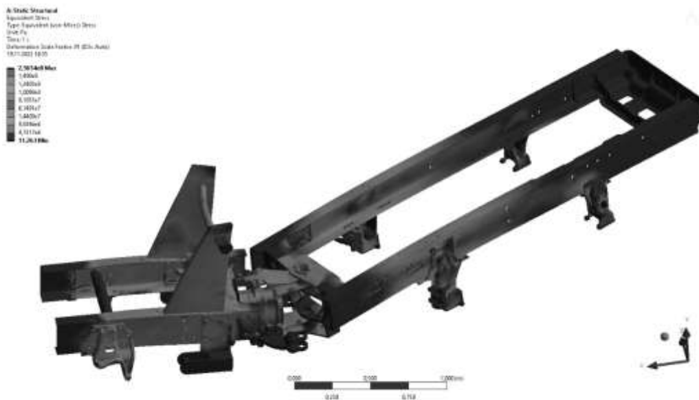
Рис. 3 – Навантаження рами у другому розрахунковому положенні.
