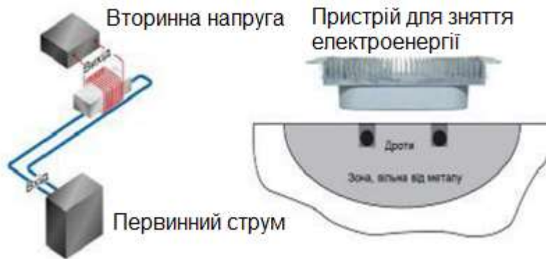
Рисунок 1 – Принцип дії та конструкція пристрою бездротової передачі електроенергії фірми VАНLE
