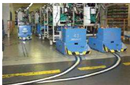
Рисунок 4 – Транспортні роботи з бездротовим живленням
